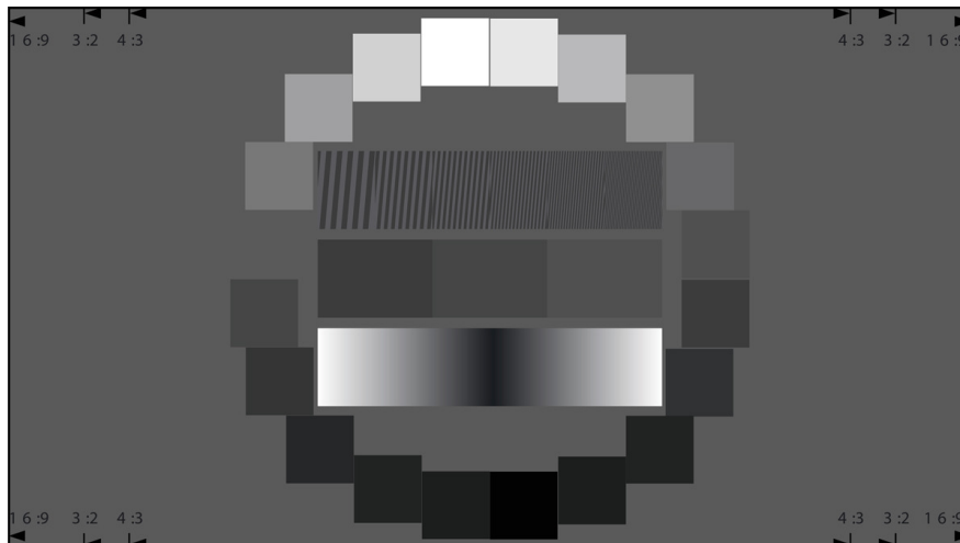
TE 241 OECF/Noise Chart bestehend aus 20 Graufeldern, Kontrast 10.000:1 (ISO 14524, ISO 15739)
