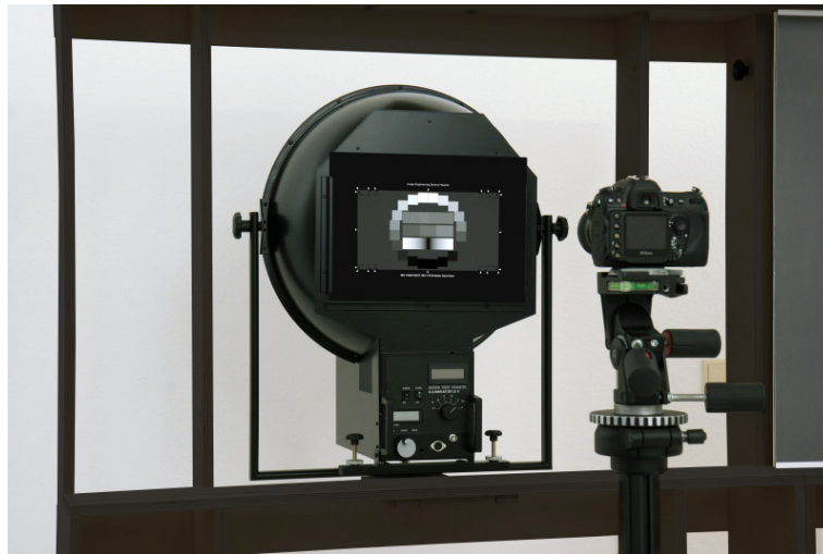
Das OECF Chart wird mit Hilfe einer Ulbrichtkugel beleuchtet und mit der digitalen Kamera aufgenommen.
