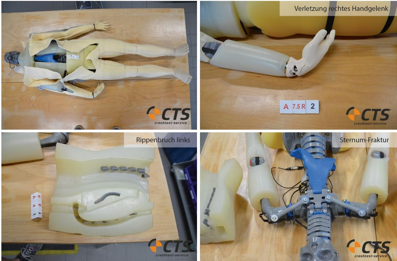
**BILD 22:** Verletzungen des ordnungsgemäß angegurten PRIMUS
