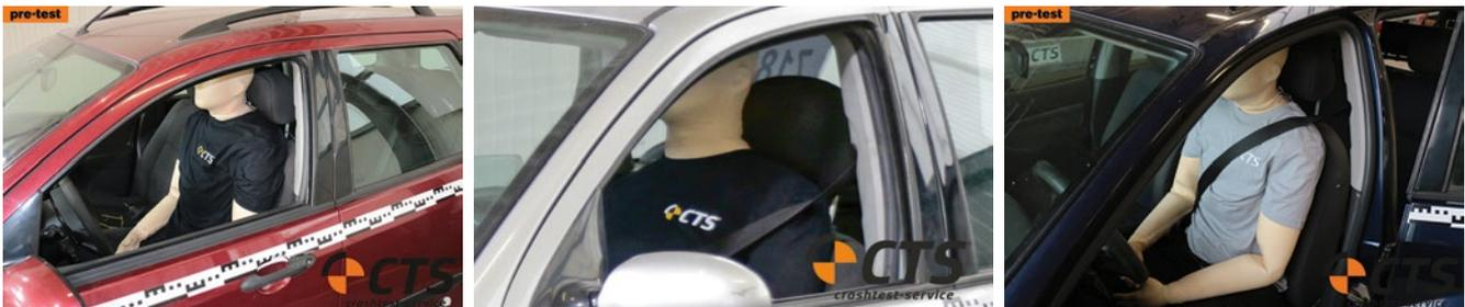
**BILD 3:** Grad der Gurtnutzung bei den Versuchen: nicht angegurtet (links), Brustgurt neben der linken Schulter verlaufend (Mitte) und ordnungsgemäß angegurtet (rechts)
