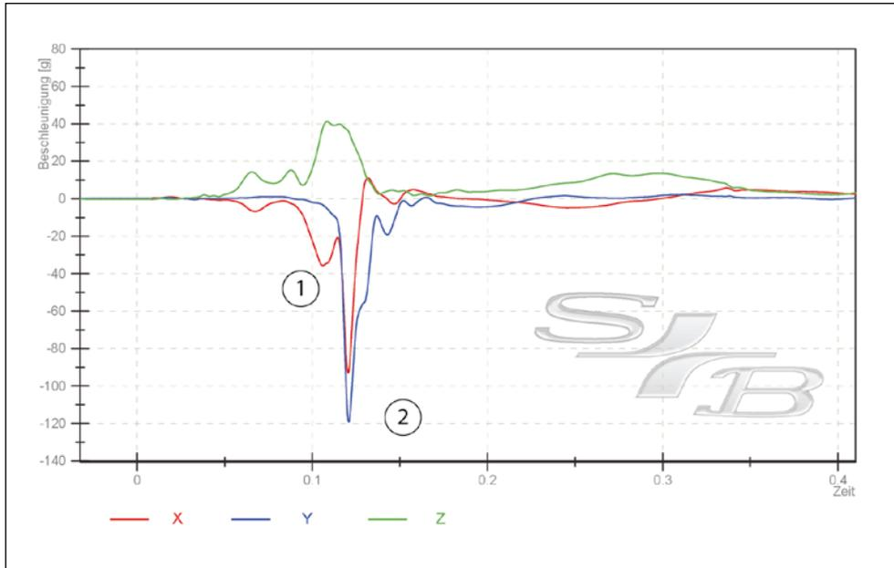
**BILD 10:** Kopfbeschleunigung des schlecht angegurten Insassen in x-, y- und z-Richtung
