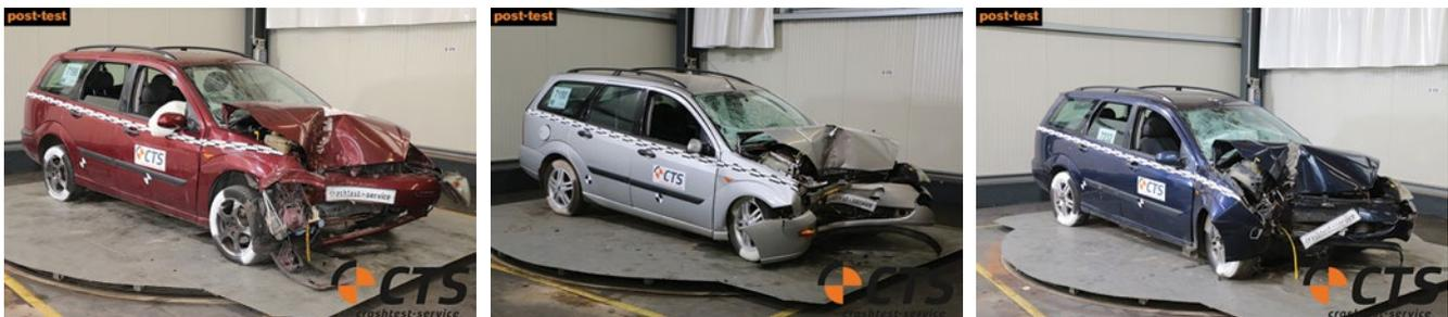
**BILD 6:** Gegenüberstellung der Fahrzeugbeschädigungen aus der Versuchsreihe
