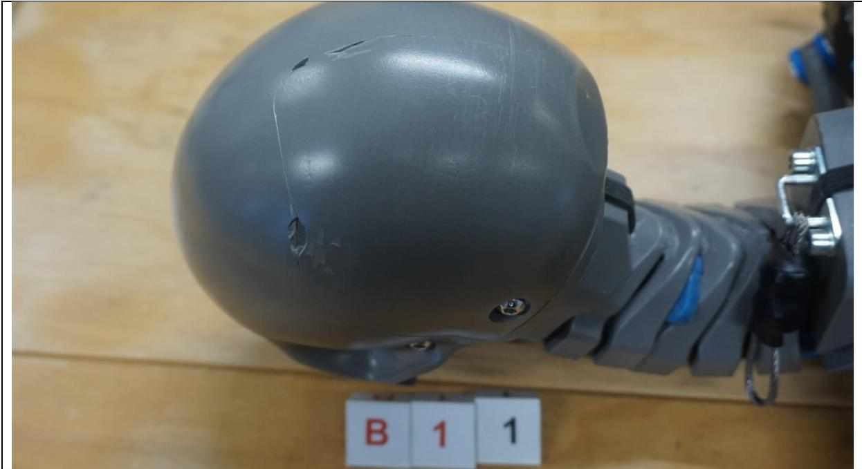
Bild 15: Beschädigung des Schädelknochens
