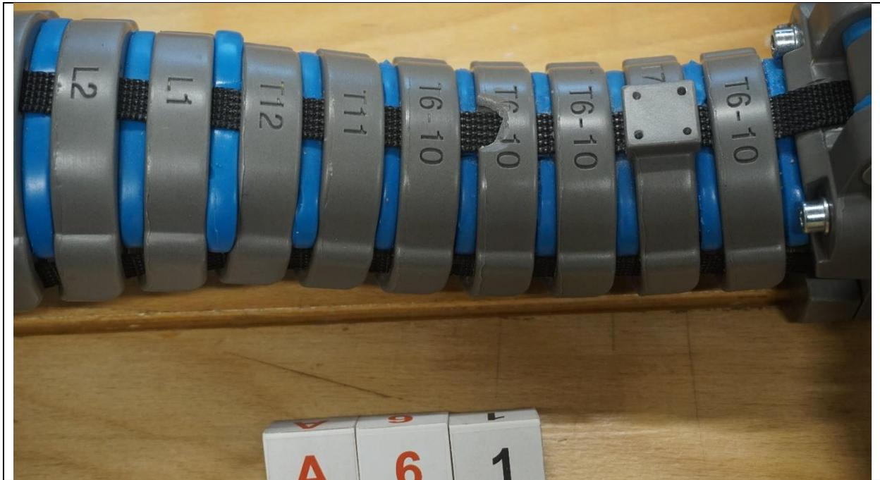
Bild 11: Beschädigung des T9-Wirbels
