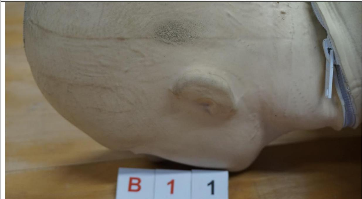
Bild 2: Beschädigung des Hautersatzes links am Kopf
