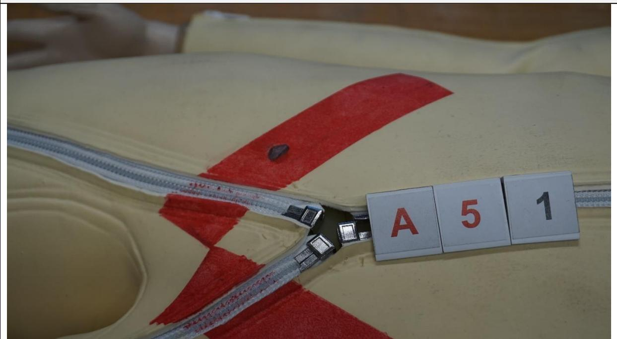
Bild 4: Beschädigung des Hautersatzes im rechten Hüftbereich
