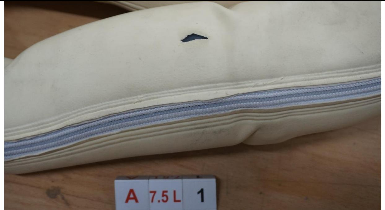
Bild 3: Beschädigung des Hautersatzes am linken Oberarm
