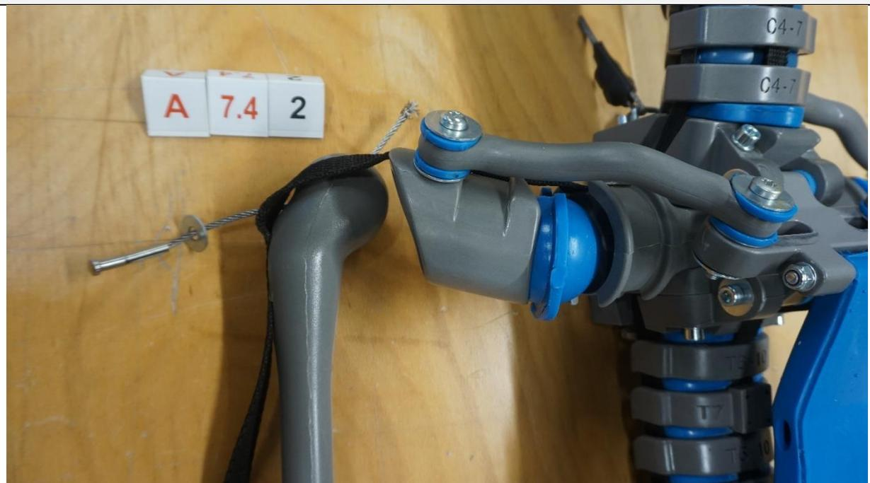
Bild 10: Lösen des Stahlseils an der rechten Schulter
