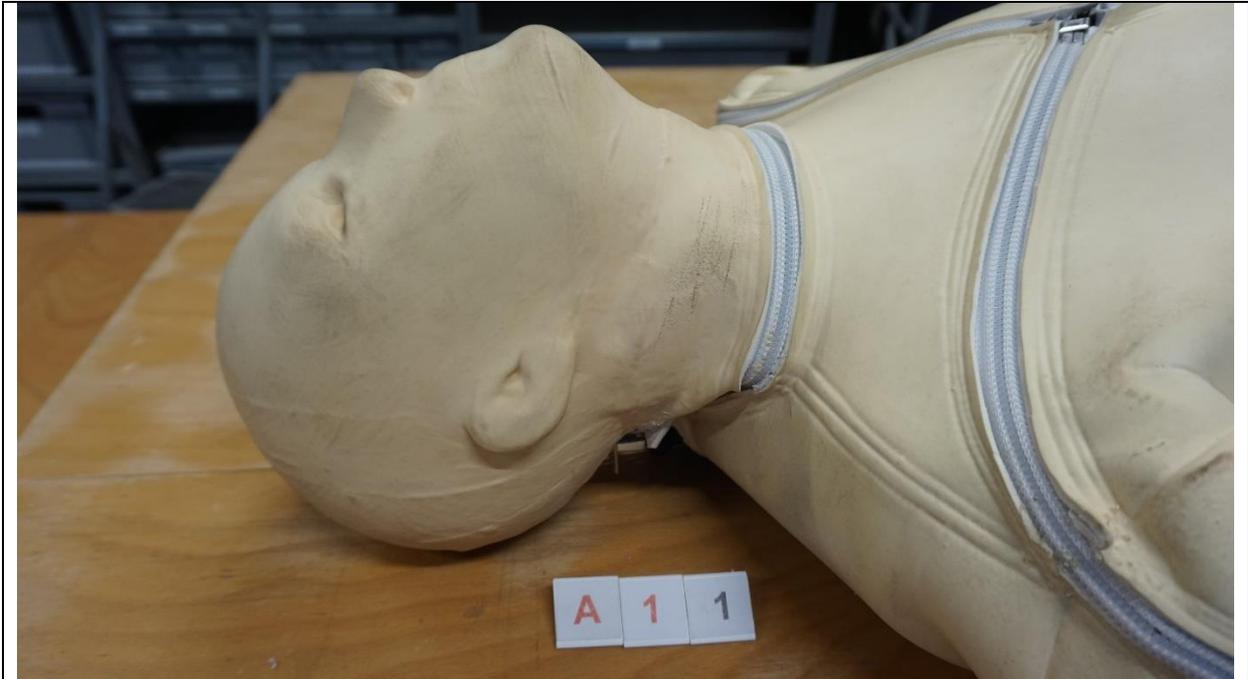
Bild 1: Beschädigung des Hautersatzes am Hals
