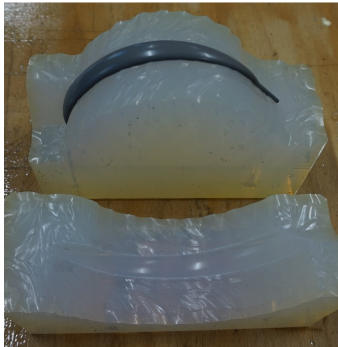
Abbildung 80: Fertig gegossene Rippe in halbseitig geöffneter Silikonform
