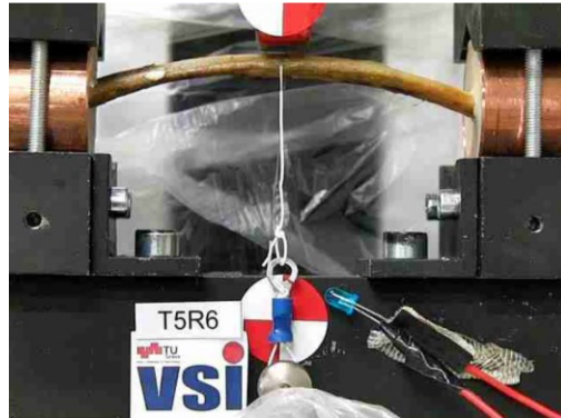
Abbildung 73: Prinzipieller Versuchsaufbau mit eingespannter Rippe [80]
