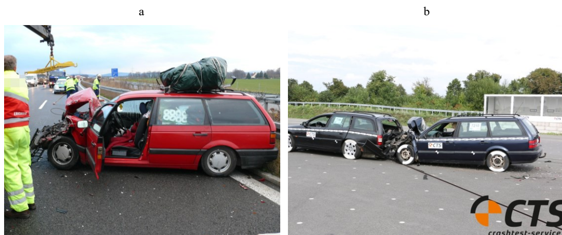
Abbildung 60: Auffahrunfall 75 km/h Post-Crash, a) Realfall [114], b) Crashtest [123]
