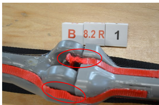
Abbildung 99: B8.2R-1 Außenband MCL Dehnung und Innenband PCL Riss
