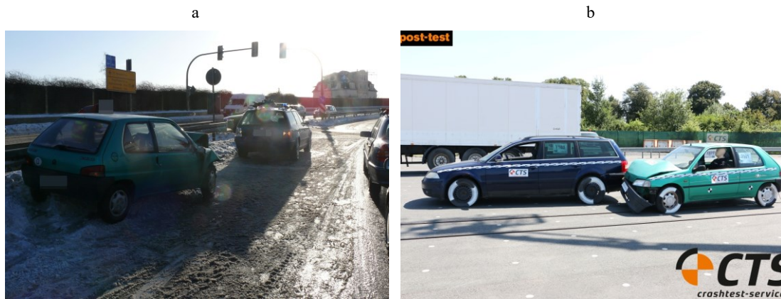
Abbildung 61: Auffahrunfall 30 km/h Post-Crash, a) Realfall [115], b) Crashtest [123]
