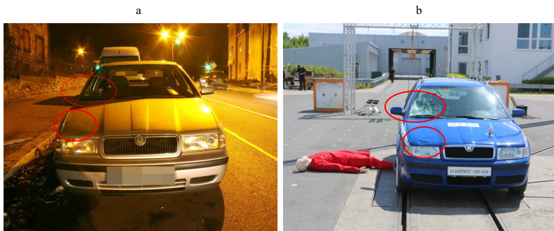
Abbildung 56: Fußgängerunfall 35 km/h Post-Crash, a) Realfall [110], b) Crashtest [123]
