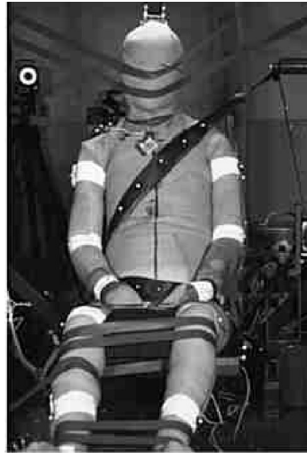
Abbildung 42: Leichenversuch mit der Fixierung für die seitliche Anprallkonstellation [107]
