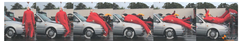
Abb. 5: Bewegungsablauf des Biofidel-Dummys im Crashversuch (gespiegelt)
