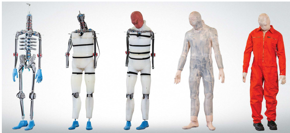
Abb. 2: Fertigungsstufen eines Biofidel-Dummys
