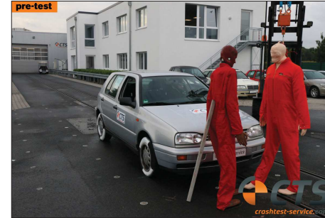
Abb.3: Anstoßkonfiguration: konventioneller Dummy links, Biofidel-Dummy rechts
