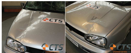
Abb. 8: Kontaktsuren auf der Motorhaube des NAMI (L) und des Biofidel-Dummys (R)
