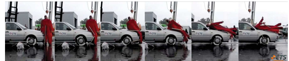
Abb. 4: Bewegungsablauf des NAMI-Dummys im Crashversuch
