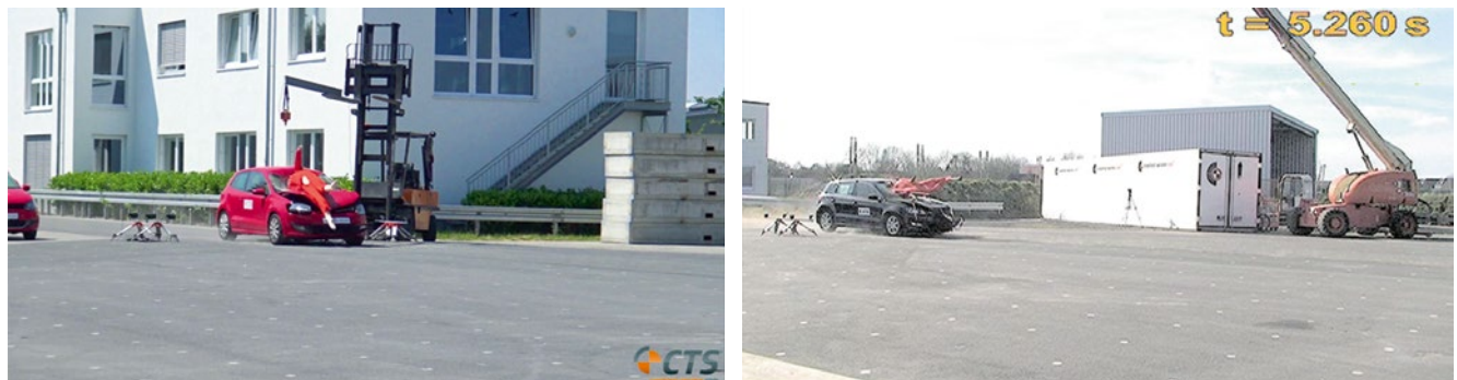
BILD 2: Nachstellung (links – Biofidel) der bereits vorhandenen Crashversuche (rechts – konventionell) – Kollisionsgeschwindigkeit hier v = 68 \text{ km/h} FIGURE 2: Re-enactment (left – biofidelic) of the already available crash tests (right – conventional) – collision velocity here: v = 68 \text{ km/h}
