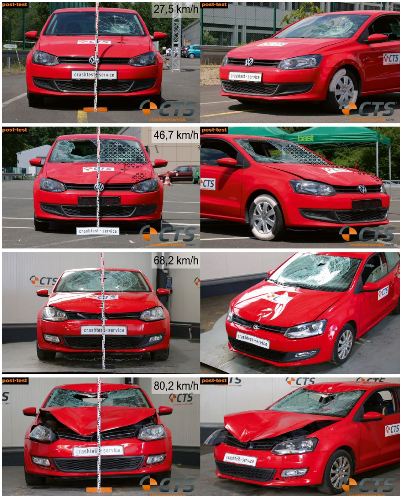
BILD 3: Veränderung des Schadenbilds (Anprall gegen Biofidel) am VW Polo 6R bei steigender Kollisionsgeschwindigkeit von 27,5 bis 80,2 km/h in der Front- und Seitenansicht
