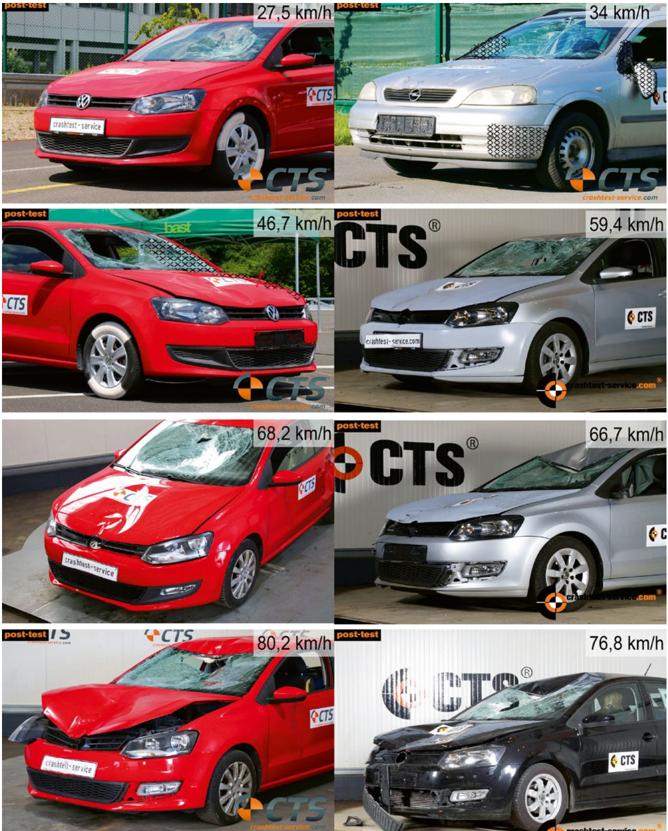
BILD 6: Schadenvergleich VW Polo 6R bei Anprall an einen Biofidel- (links)/konventionellen Dummy (rechts) bei zunehmender Kollisionsgeschwindigkeit (Seitenansicht)
