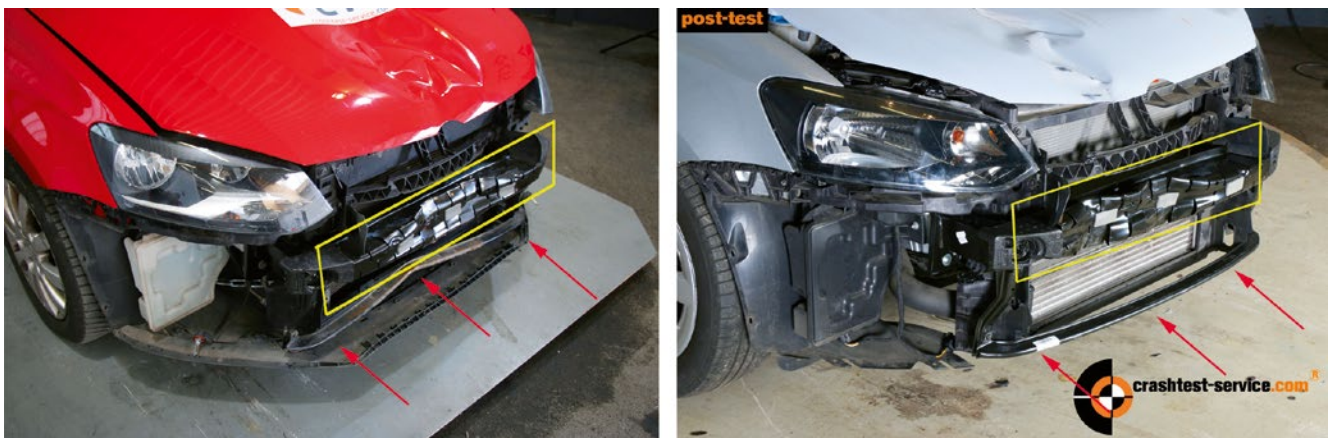
BILD 7: Vergleich der Frontbeschädigung der Crashfahrzeuge (Stoßfänger demontiert) nach Kollision mit einem Biofidel- (links) und konventionellen Dummy (rechts) bei v=70 km/h
