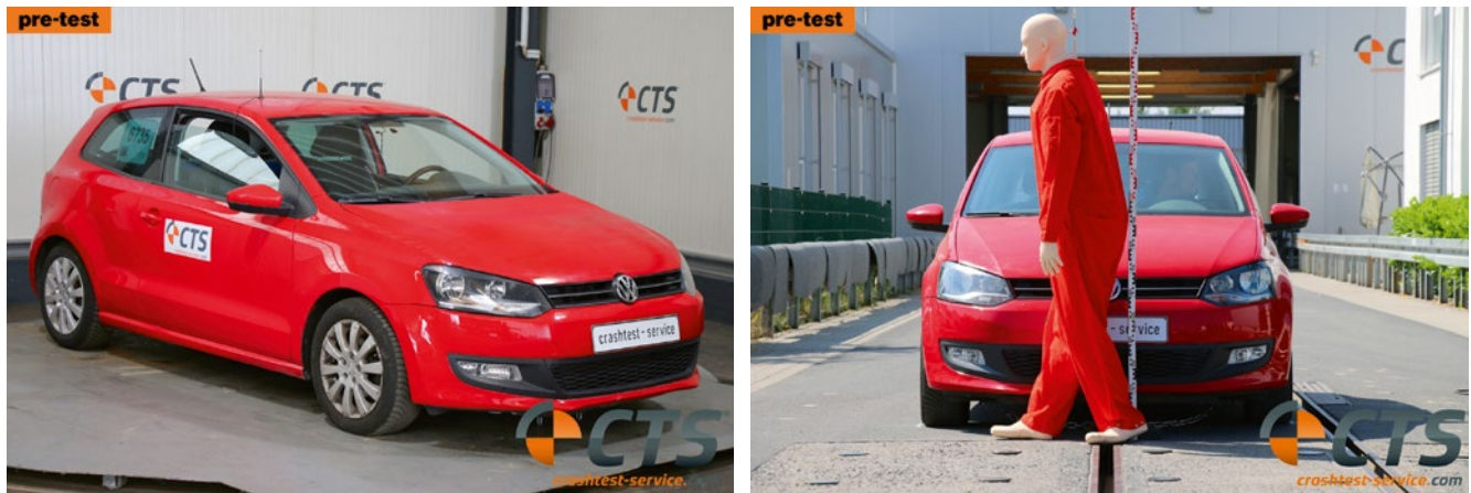
BILD 1: Crashfahrzeug VW Polo 6R (links) und Anstoßsituation mit Biofidel-Dummy (rechts) für die durchgeführte Crashserie FIGURE 1: Crash test vehicle VW Polo 6R (left) and impact situation with a biofidelic dummy (right) for the crash series performed
