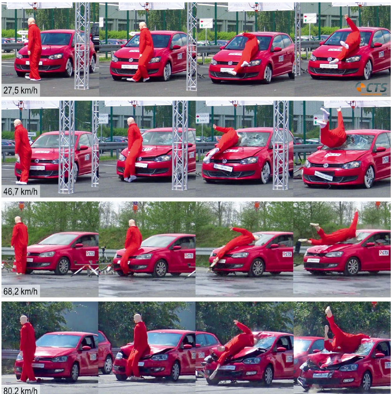
BILD 4: Bewegungsablauf des Biofidel-Dummys und Kopfanprallhöhe mit zunehmender Kollisionsgeschwindigkeit
