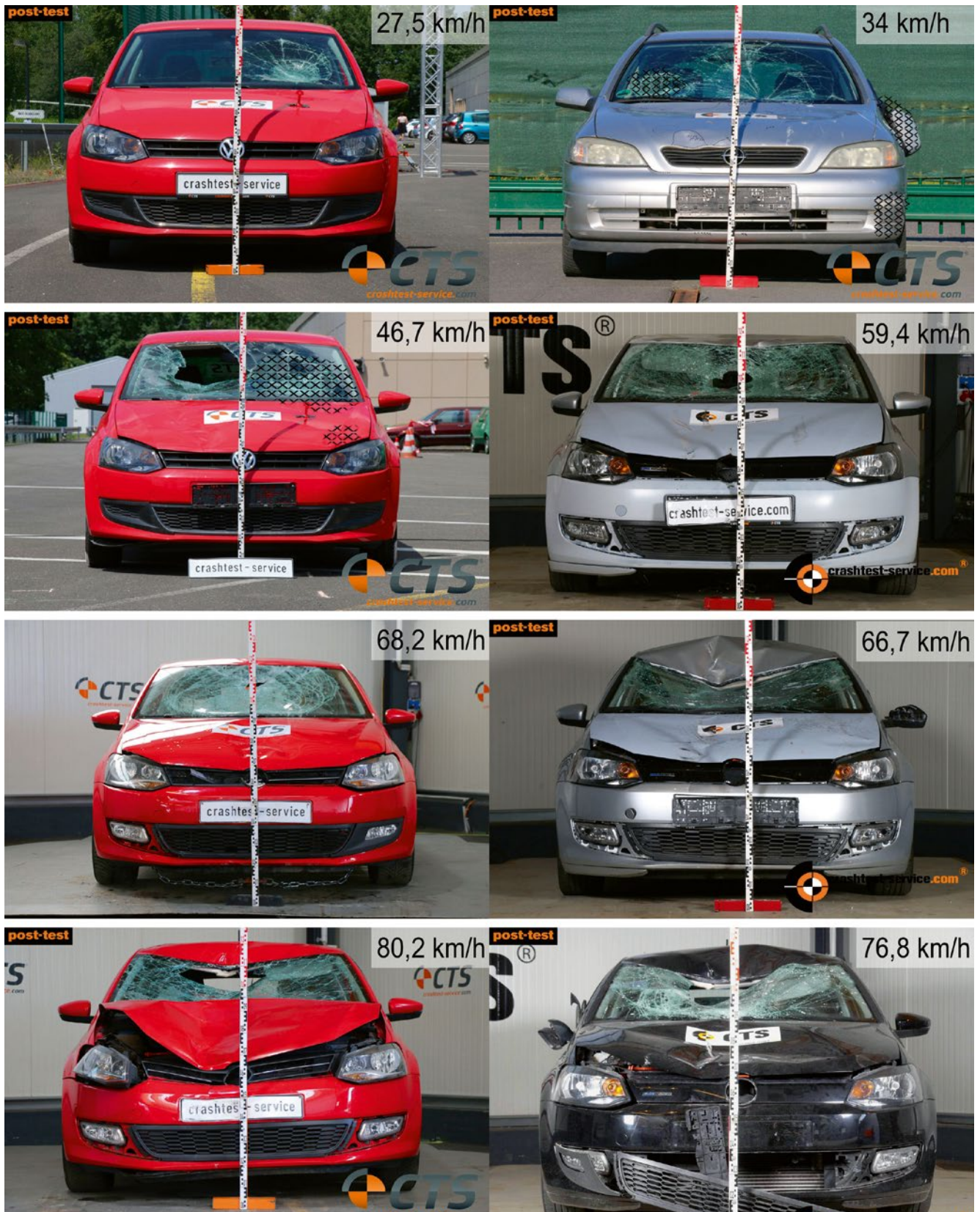
BILD 5: Schadenvergleich VW Polo 6R bei Anprall an einen Biofidel- (links)/konventionellen Dummy (rechts) bei zunehmender Kollisionsgeschwindigkeit (Frontansicht)
