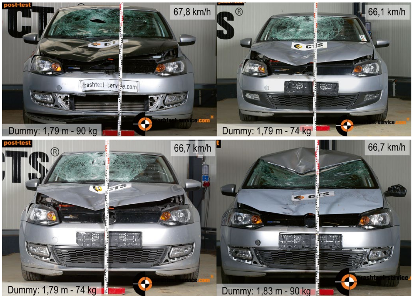
BILD 9: Schadenvergleich am VW Polo 6R beim Anprall gegen einen konventionellen Dummy im Geschwindigkeitsbereich von 66 bis 68 km/h FIGURE 9: Comparison of the damage to the VW Polo 6R after an impact with a conventional dummy in the velocity range from 66 to 68 km/h
