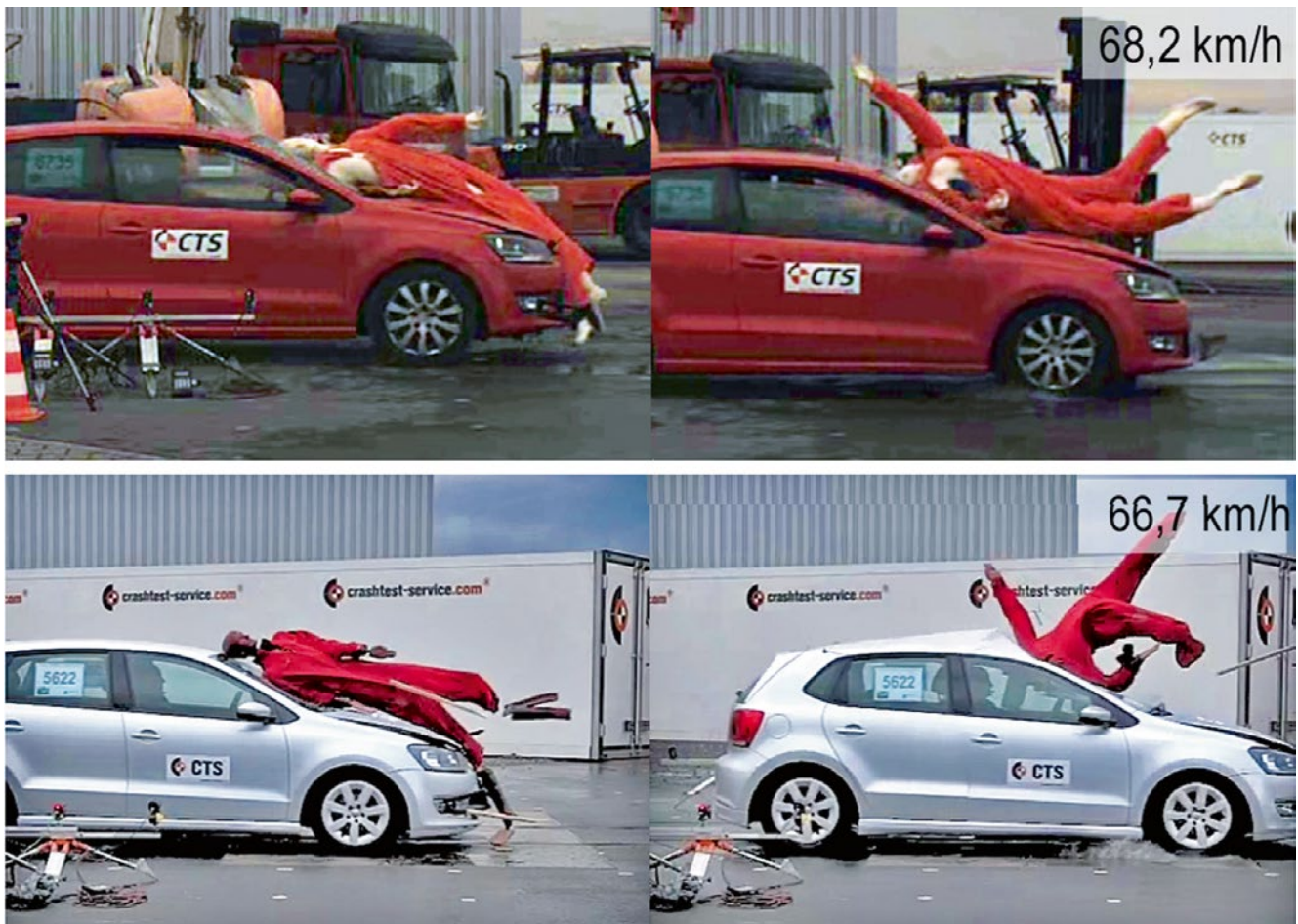
BILD 10: Verformung der Dachkante beim Anprall des Biofidel- (oben) und konventionellen Dummys (unten) bei rund 70 km/h
