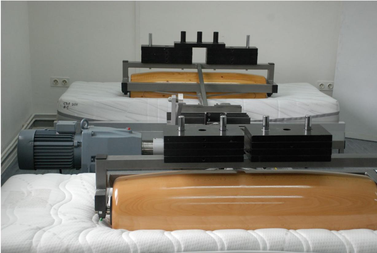
Dauerhaltbarkeitsprüfung nach DIN EN 1957. Die Simulation bei dieser Prüfung soll einer Nutzungsdauer der Matratze von 8-10 Jahren entsprechen.
