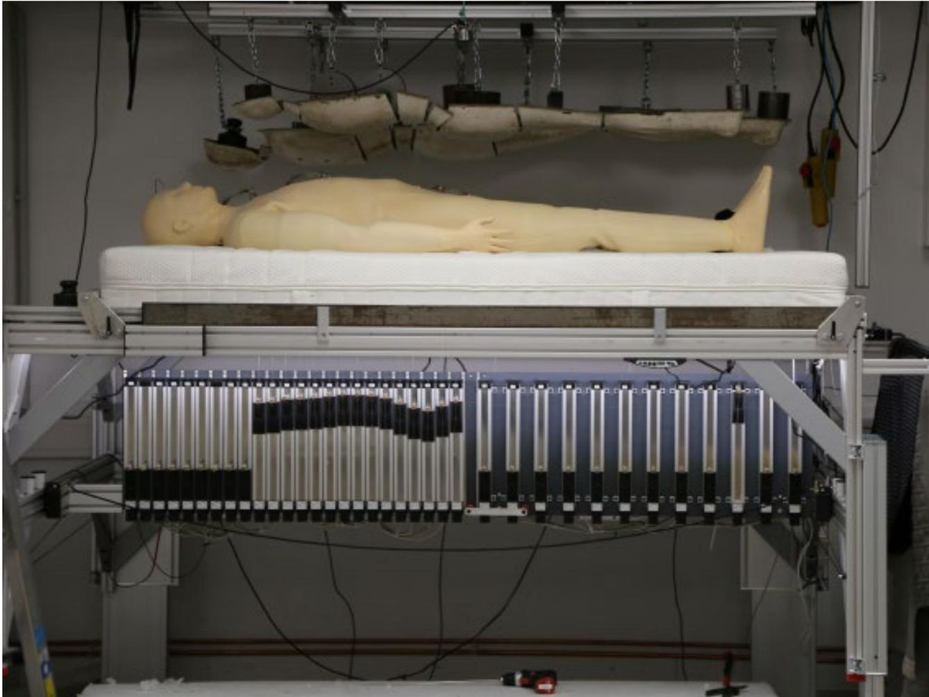
Erste Messungen mit dem CTS-Dummy des 95. Körperhöhen- perzentils zur Evaluation der mit Versuchspersonen ermittelten Einsinktiefen bei Rückenlage in den Matratzenkern
